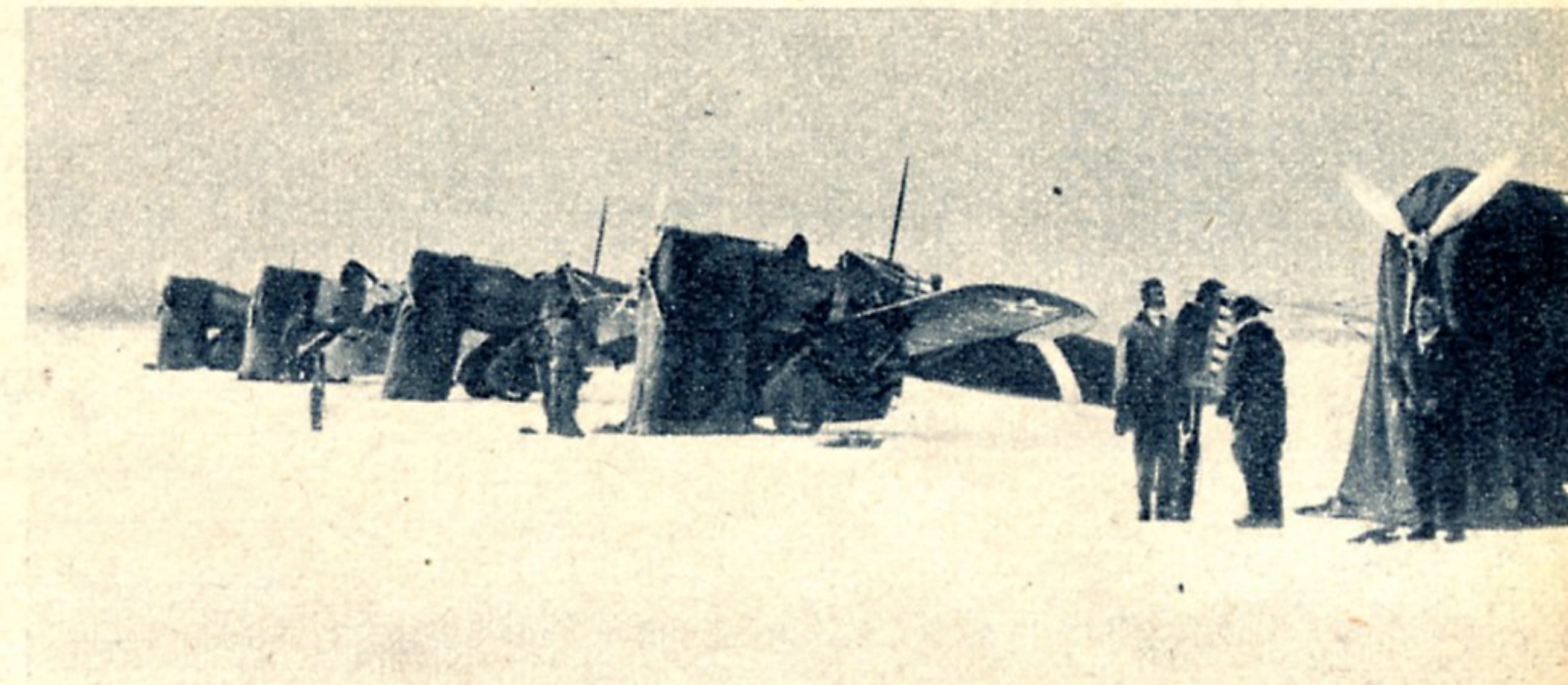
So wärmen die Amerikaner ihre Motoren im Winter vor. Unter einer Schutzhaube, die den ganzen Motor umschließt und bis auf den Boden reicht, steht ein Katalyt-Ofen, der den Motor auf die erforderliche Startwärme bringt
