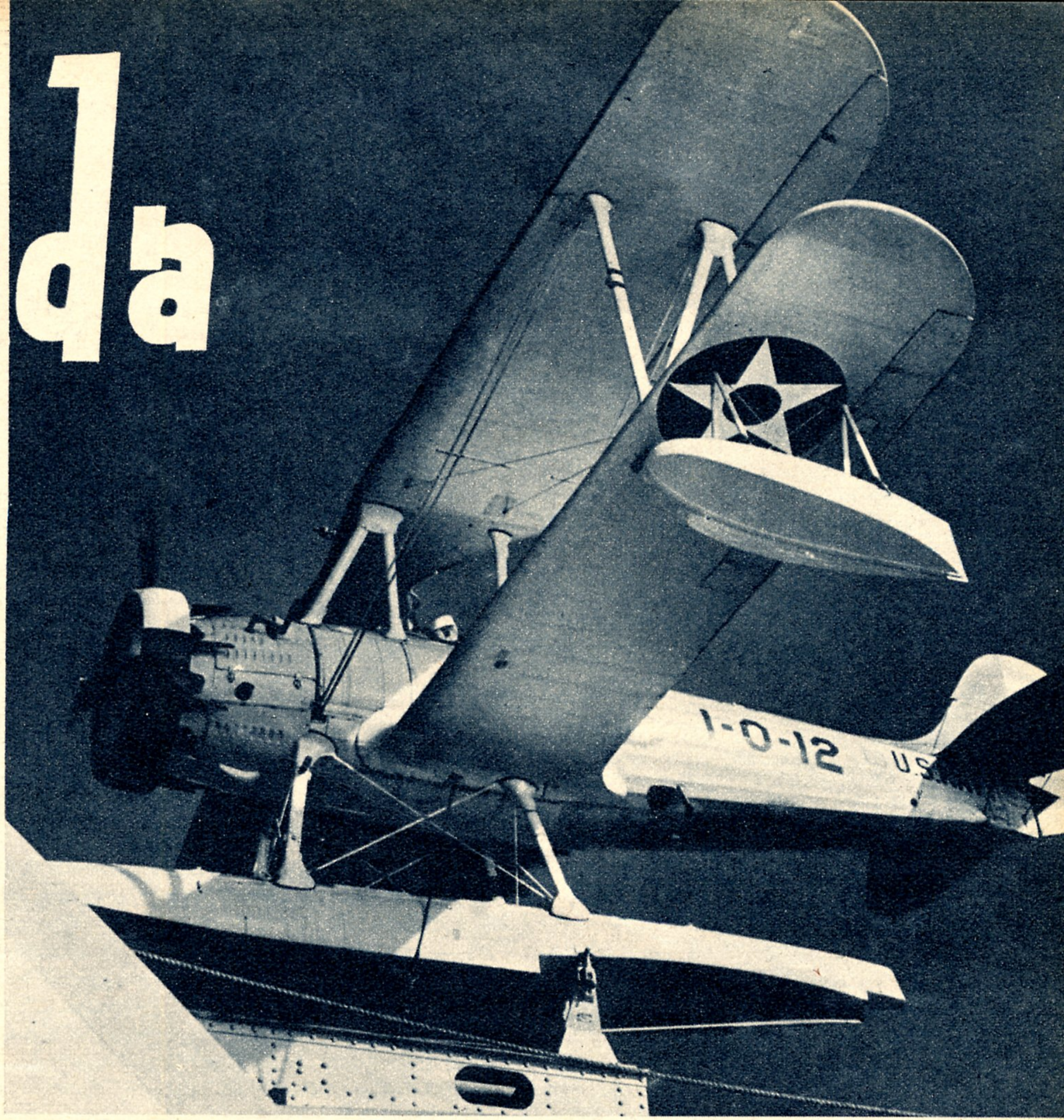
Ein Seeraufklärungsflugzeug mit einem 700 PS Hornet-Motor auf der Katapultschiene eines Kreuzers
