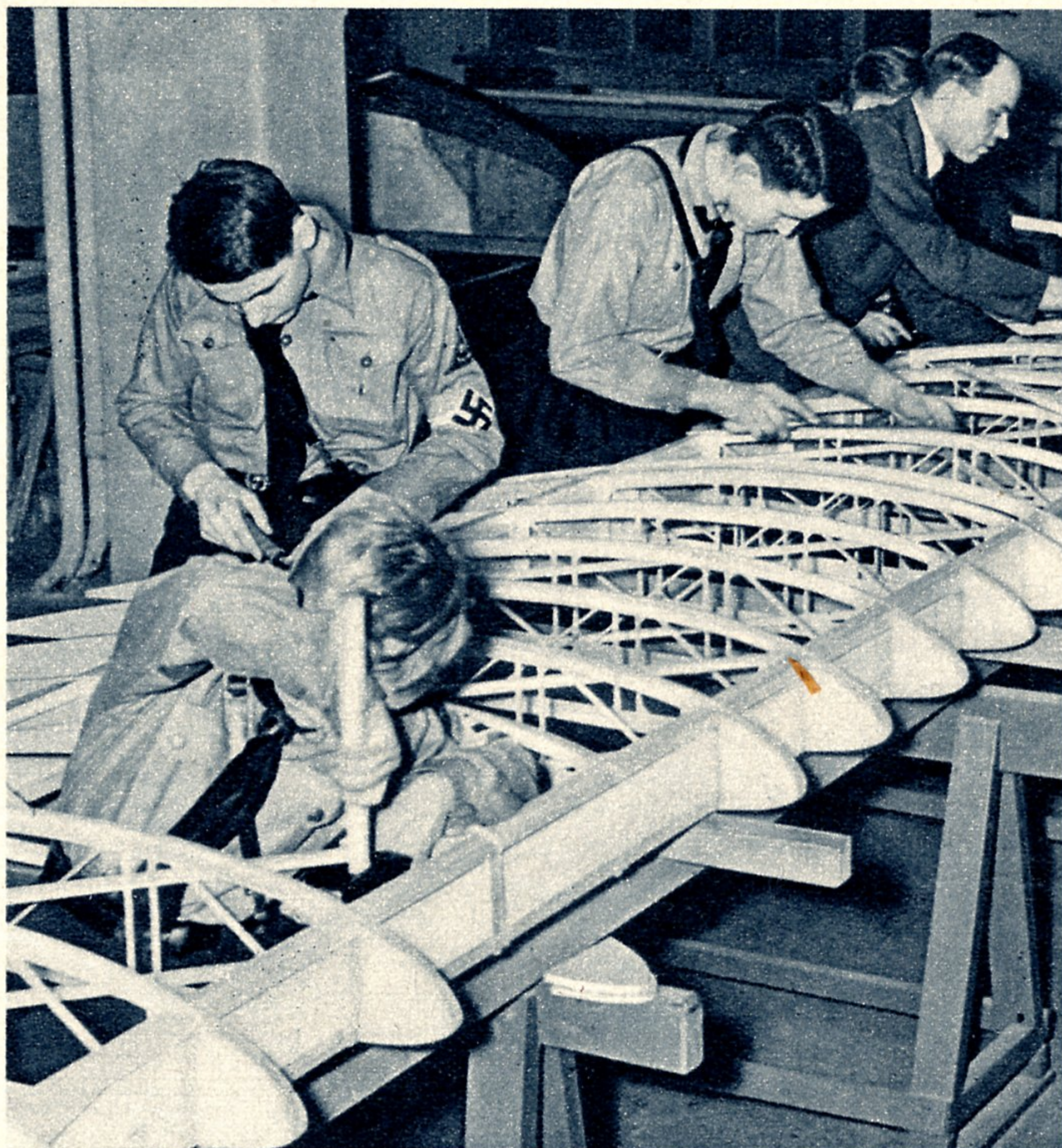
Rippe an Rippe wird in sorgfältigster Arbeit, bei der es auf jede Kleinigkeit ankommt, zum Tragflügel aneinandergesetzt. Wer selber viele Stunden und Tage am Bau einer „Kiste“ mitgewirkt hat, wird auch später sein Segelflugzeug richtig zu behandeln verstehen Aufnahme Scherl
